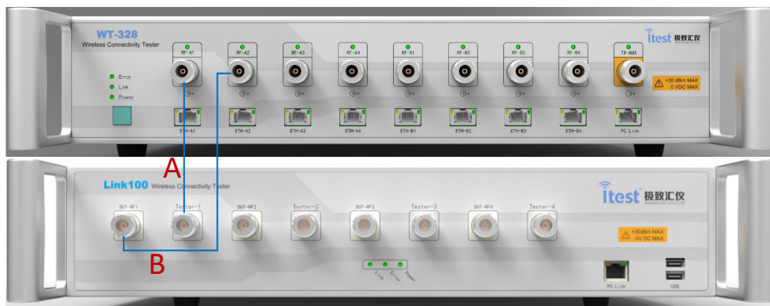
图 4-2 TX/RX测试线衰校准连线示意图
