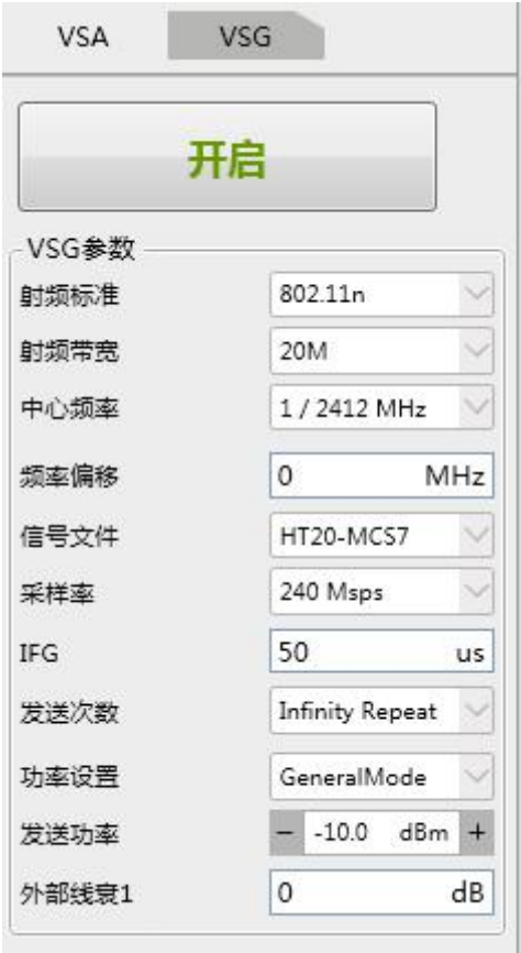
图 2- 17 Meter MIMO VSG 常用设置项
