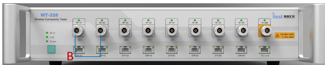
图 4-3 RvR 测试线衰校准接线图
