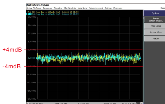
VNA485超低迹线噪声 幅度:<0.004dB RMS 相位:<0.015°(IFBW: 70kHz)
